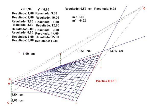
Enunciado Los ingenieros suelen construir un paraboloide hiperbólico (un *PH* según su jerga), a partir de un bastidor cuadrado o rectangular al que se le han girado en sentidos contrarios dos lados opuestos. Después se lanzan segmentos rectilíneos a intervalos regulares que unan cada lado con su opuesto. Realícese una animación CABRI que simule el torcimiento de semejante bastidor.
